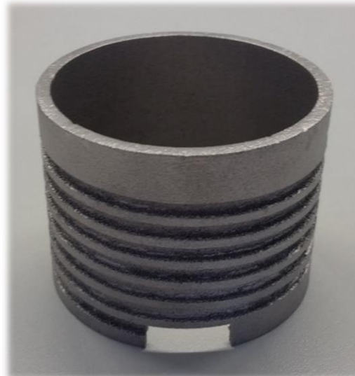
Wickelkörper für Bifilarspule (3D-Druck)
